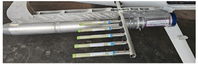
Zusätzlich an Bord: 10 Fackeln, von denen jede einzelne für ca. 7 Minuten nach der Zündung Partikel erzeugt.
