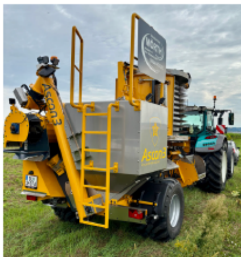
Diese Erntemaschinen ernten bis zu zwei Hektar Kürbis pro Stunde.
