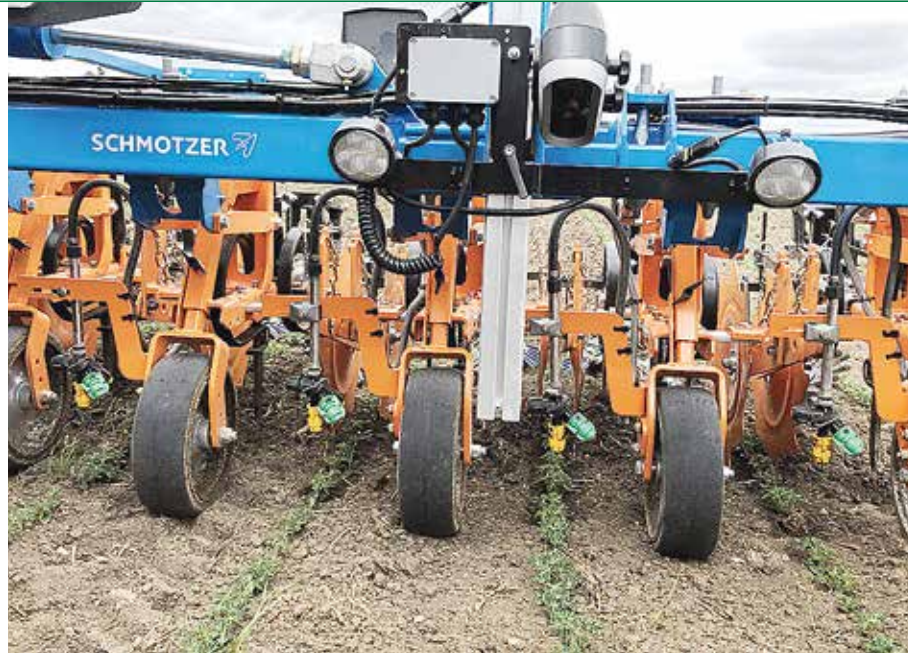
Bandspritzung, Kamerahacke und Untersaat in einer Überfahrt
