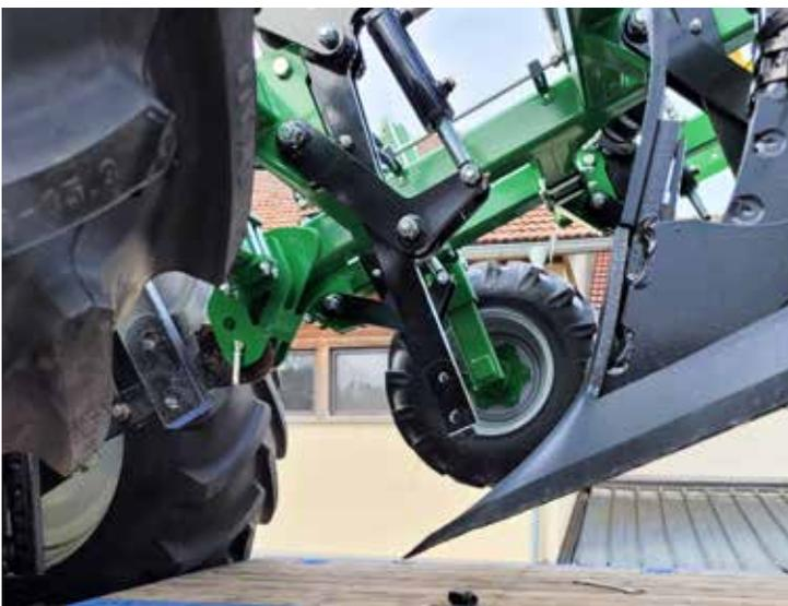
Scharfe Gänsefußschare sorgten bei sehr seichter Arbeit für guten Einzug und einen exakten Schnitt. Die Anlenkung der Zinken und der geringe Freiwinkel der Schare ermöglichten die geringe Arbeitstiefe bei gutem Einzug.
