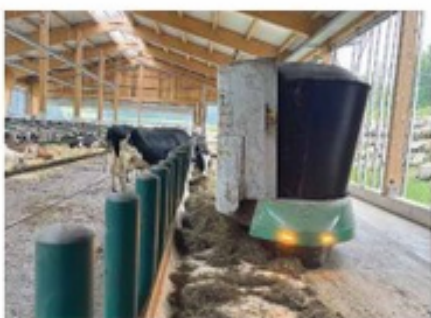
Thörler „Kuhkellner“ bei der Arbeit: Der Roboter mischt das Futter und bringt es aus.
