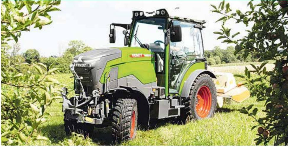
E-Traktoren sind derzeit bis 135 PS möglich, darüber wäre die Batterie unverhältnismäßig groß und schwer FENDT
