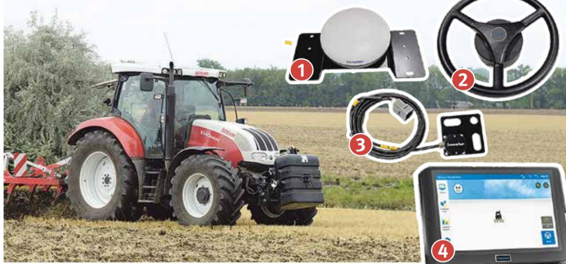
Mit einem Nachrüstkit lassen sich auch ältere Modelle via Satellit steuern. Diese Sets bestehen aus einer GPS-RTK-Antenne 1, einem Lenkradservomotor 2, der die Lenkbefehle an den Traktor überträgt, Sensoren 3, die am Lenksystem angebracht werden und einem Bedienungsterminal 4 oder -app
