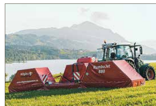
Erkennung der Unkräuter mittels Multispektralkamera und Besprühen über 88 einzeln schaltbarer Düsen
