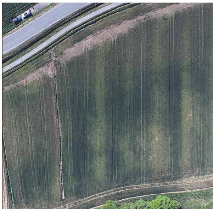
Gülle am Steilhang: Füllstand und Fahrgeschwindigkeit schwanken
