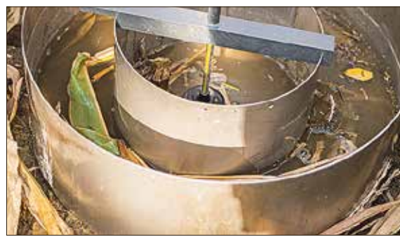
Mit einem solchen Gerät misst die Landwirtschaftskammer in Versuchen, wie schnell der Boden Wasser aufnehmen kann DANNER
