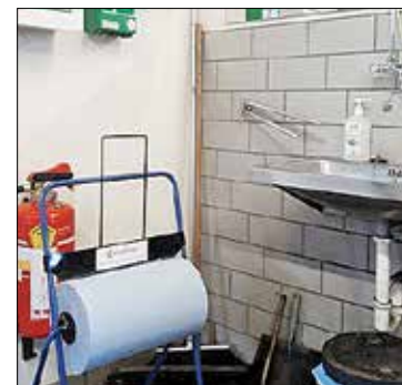
Ein Waschbecken mit Spiegel, ein „Erste Hilfe Koffer“, ein Augenspülset und ein Feuerlöscher dürfen in keiner Werkstatt fehlen DIEM (5)
