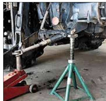
Ein Wagenheber dient zum Anheben der Maschine, gearbeitet darf erst werden, wenn der Traktor mit Unterstellbock gesichert ist DIEM (5)
