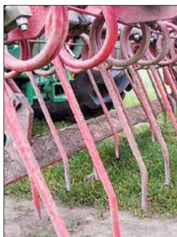
Solche Zinken öffnen die Grasnarbe. Bei einer Schlitzsaat müssen die Lücken bereits vorhanden sein, wie das rechte Bild zeigt. LK
