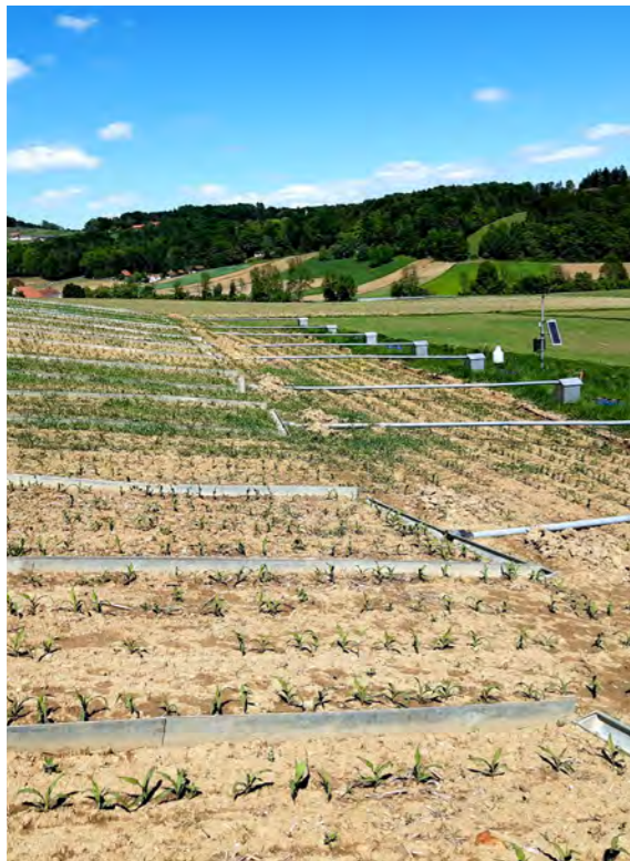
FOTO Messung des Bodenabtrags mittels Erosionsfallen; © LK Steiermark
