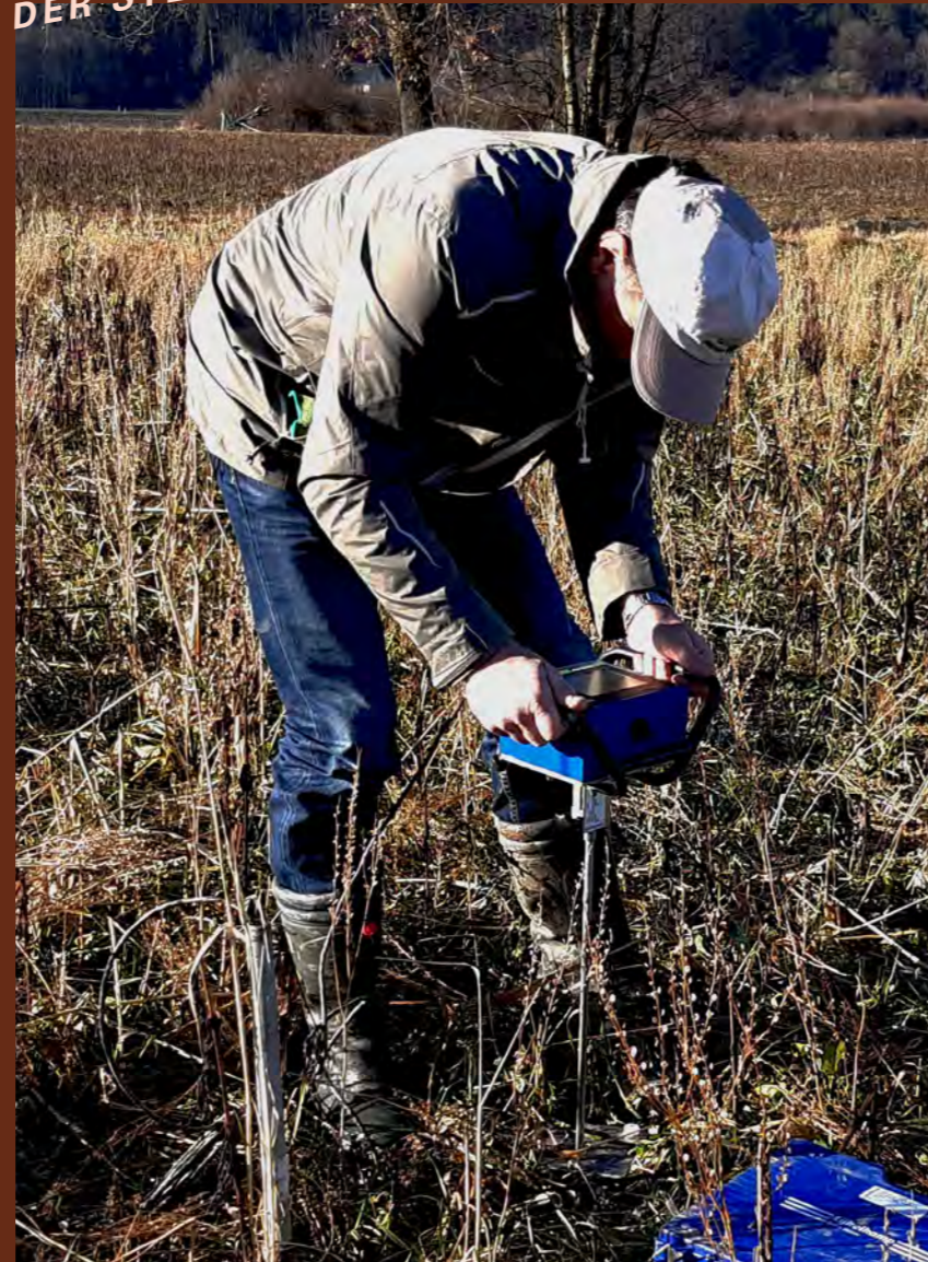
FOTO Bodenverdichtungsmessung (Penetrologger); © LK Steiermark
