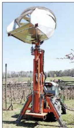
Windmaschinen durchwirbeln die Luftschichten.
