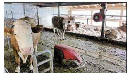
**Robotik.** Robotertechnologie nur für große Betriebe? Schon längst nicht mehr gültig. Was für die „Großen“ erdacht wurde, kann auch für die „Kleinen“ interessant und wirtschaftlich sinnvoll sein. Wie etwa hier zum Reinigen der Lauffläche.
