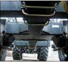
Keine freiliegenden Schläuche oder Hebel unter dem Hänger.
