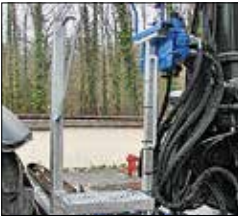
Gesäßstütze und rutschfeste Plattform für sichere Arbeit.
