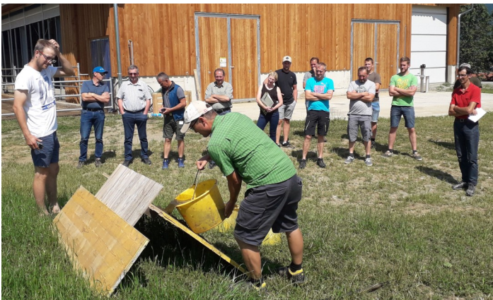
Schaltafeltest Fließverhalten von Gülle. ©AK Milch
