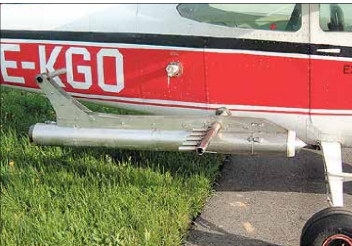
Rauchgasgenerator und Düsen: Damit werden Gewitterwolken geimpft.
