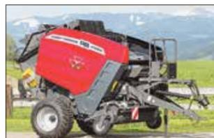
Presse mit den flexiblen Pickupzinken und längsten Messern
