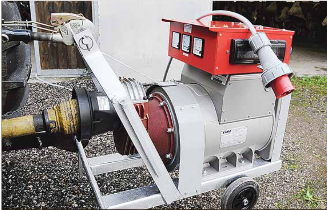
Zapfwellengeneratoren sind in der Regel die günstigere und technisch bessere Notstromlösung. WOLFGANG DÜRNBERGER
