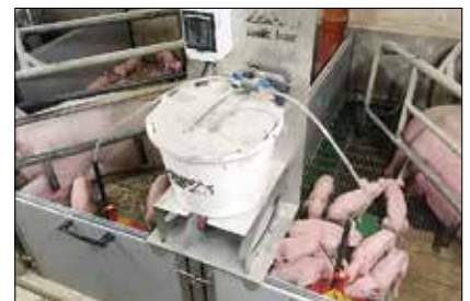
Einfacher Automat wird mit per Hand angerührter Milch befüllt. Mittels Zeitschaltuhr wird ausdosiert. HUMER
