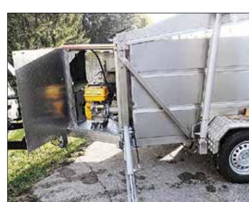
Im vorderen Teil des Hängers befinden sich Benzinmotor, Hydraulikaggregat und Handwaschbecken
