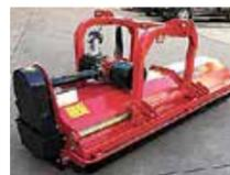
**Schlegelmulcher Aktion** von 160-240 cm. AB z.B. 200 cm mit Front und Hecktrieb, hydraulischer Verschluss, 4-fach Keilriemen, 1.300 Gramm Schlegel, Gelenkwelle, € 2.590,- inkl. MwSt.
