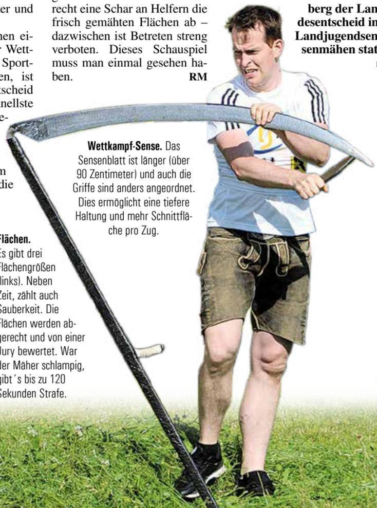
**Wettkampf-Sense.** Das Sensenblatt ist länger (über 90 Zentimeter) und auch die Griffe sind anders angeordnet. Dies ermöglicht eine tiefere Haltung und mehr Schnittfläche pro Zug.
