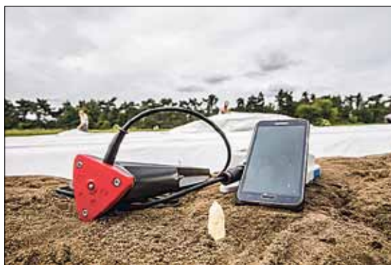
Ein Messpflock erfasst die Temperatur in vier Zonen im Erddamm und sendet die Daten auf Reichers Smartphone BOSCH
