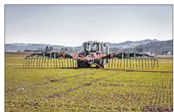
Die Gülleverschlauchung mit 15 Meter Arbeitsbreite schafft mit GPS-Unterstützung bis zu 180 Kubikmeter pro Stunde FRANZ STEINBAUER
