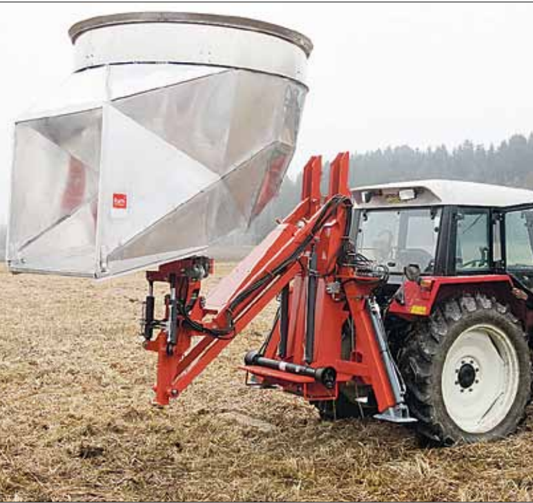
Für den Transport wird der Ausleger zusammengeklappt
